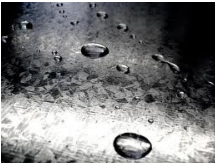
Figura 4-25 Muestra de acero galvanizado en caliente [15]
