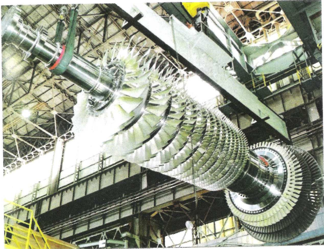
Figura 44. Rotor turbina de gas M 701 G2 (cortesía de Mitsubishi).
