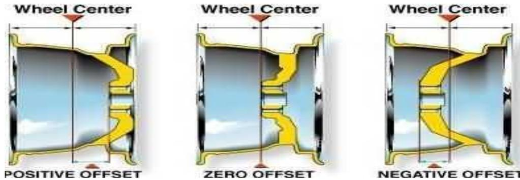
Figura 34: Esquema ilustrativo del ET (u "Offset") de la llanta
