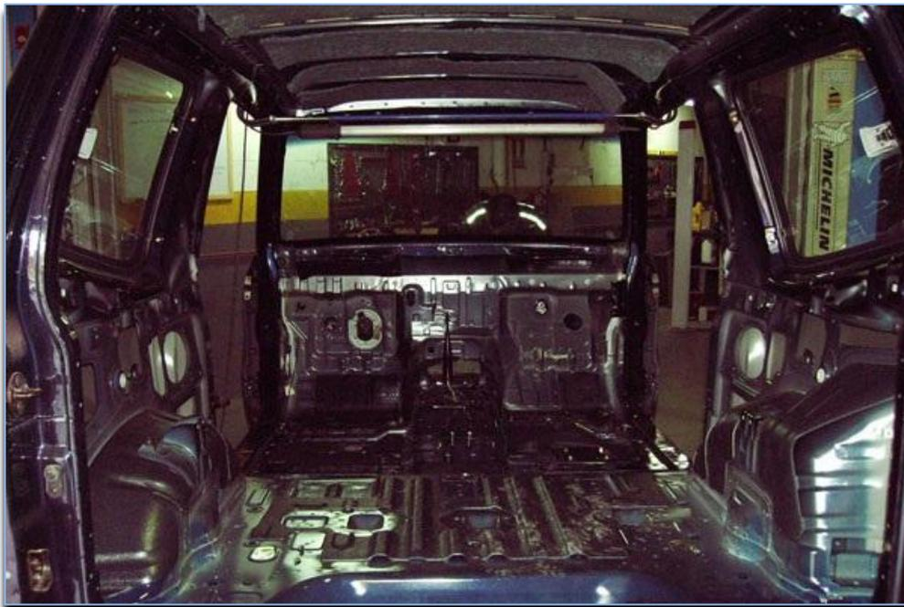
*Figura 138: vaciado completo del espacio destinado a los ocupantes*
