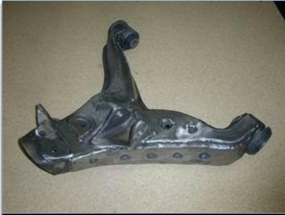
*Figura 75: Resultado orientativo del refuerzo realizado en el brazo delantero inferior*
