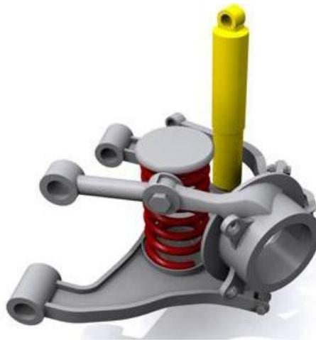
*Figura 38: Esquema básico de la suspensión trasera, suspensión multibrazo o “Multilink”*
