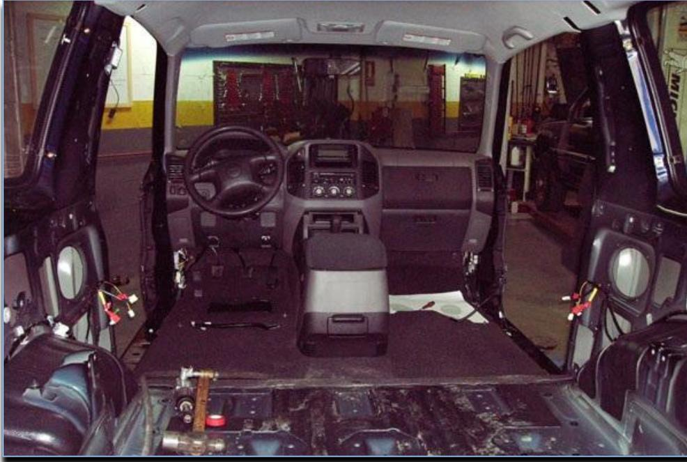
*Figura 137: vaciado completo del espacio destinado a carga*
