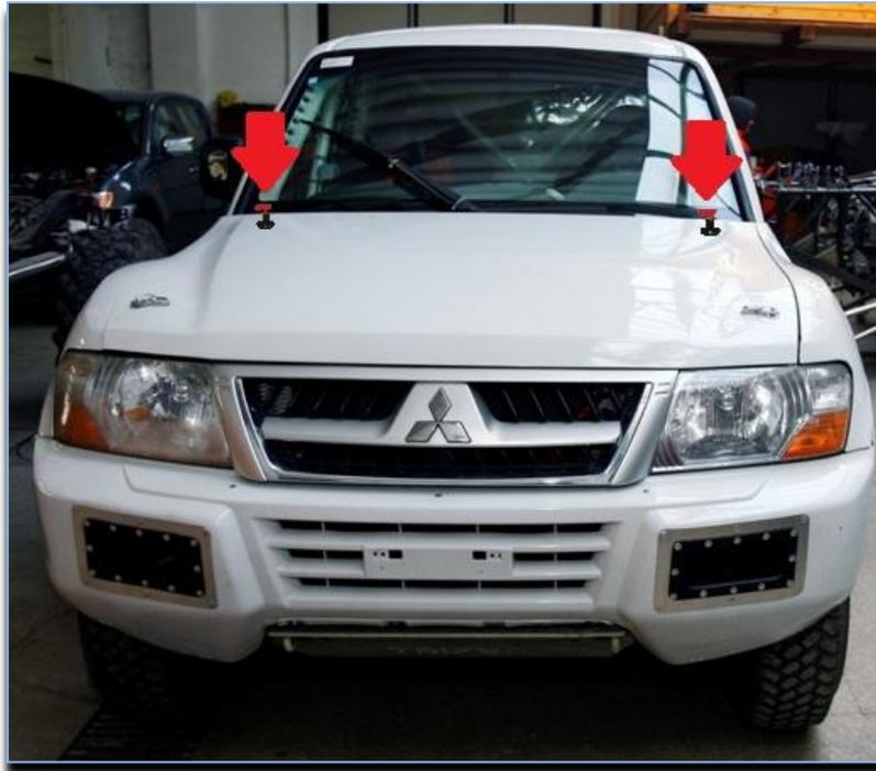
*Figura 170: Ubicación exterior de la seta de desconexión*
