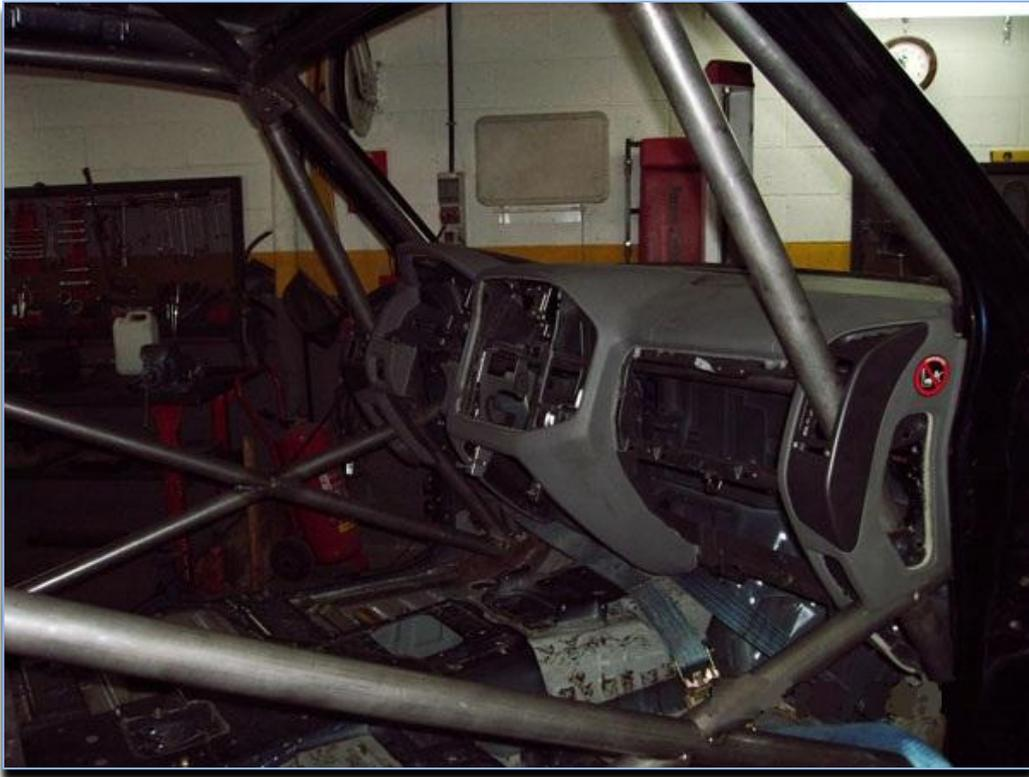
*Figura 143: instalación del salpicadero adaptado a la jaula*
