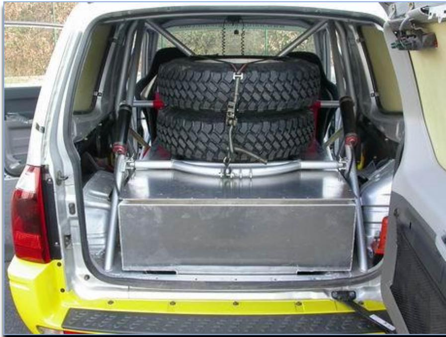
*Figura 154: figura ilustrativa de la situación final del depósito de combustible de sustitución*
