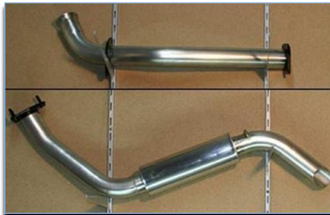
Figura 18: Elementos del sistema de escape de sustitución, del fabricante RalliArt, con ref R93884
