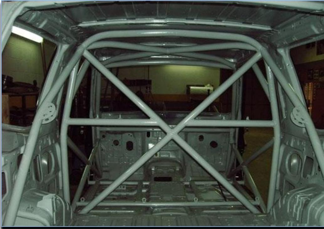
*Figura 145: Jaula de seguridad e interior imprimados*
