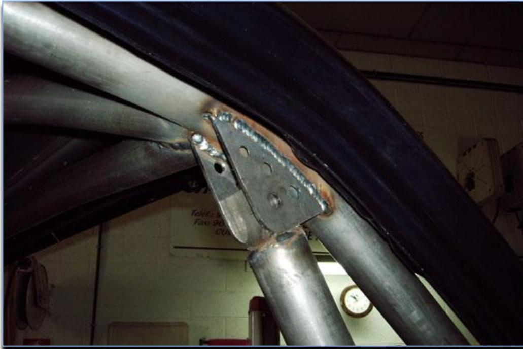
*Figura 141: detalle de los tirantes desmontables atornillados de espacio de los ocupantes*
