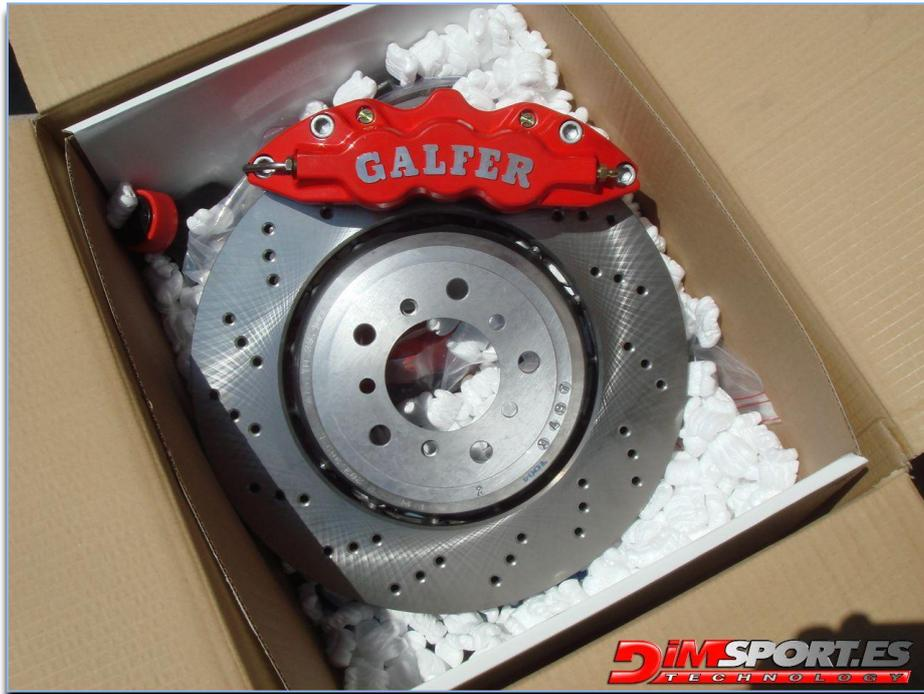
Figura 86: kit completo de frenos a instalar, delantero y trasero (Pinza Galfer, Disco sobredimensionado)
