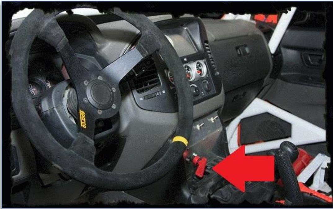
Figura 169: Ubicación interior de la seta de desconexión
