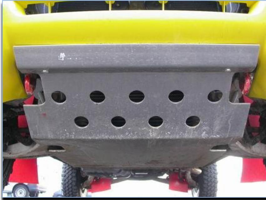
*Figura 173: Kit de protecciones de bajos del proveedor Sahara4x4, ref 192193 (2)*
