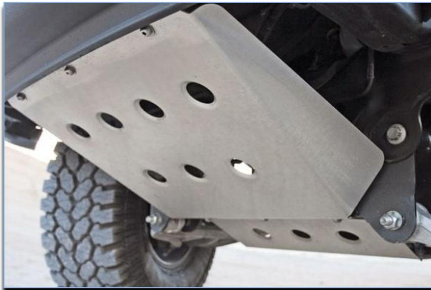
Figura 172: Kit de protecciones de bajos del proveedor Sahara4x4, ref 192193
