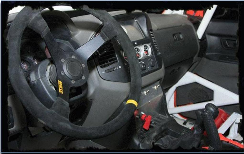
*Figura 158: Volante de competición más piña separadora instalados*
