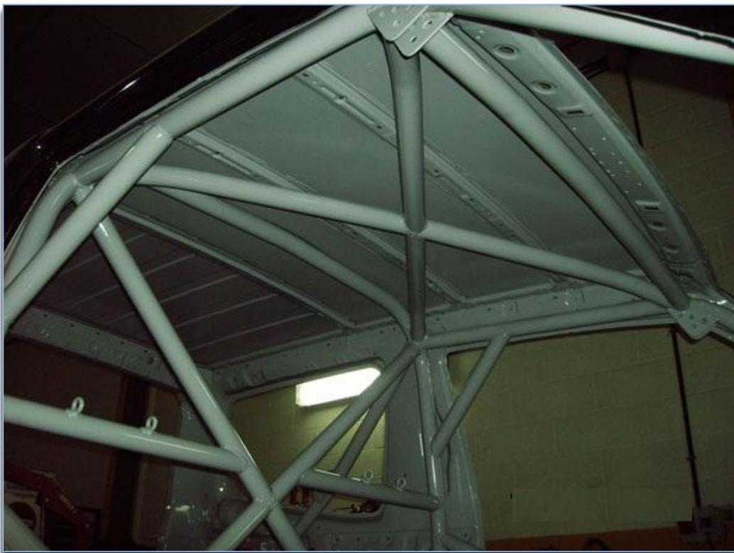
*Figura 146: detalle de la parte superior de la estructura ya instalada e imprimada*
