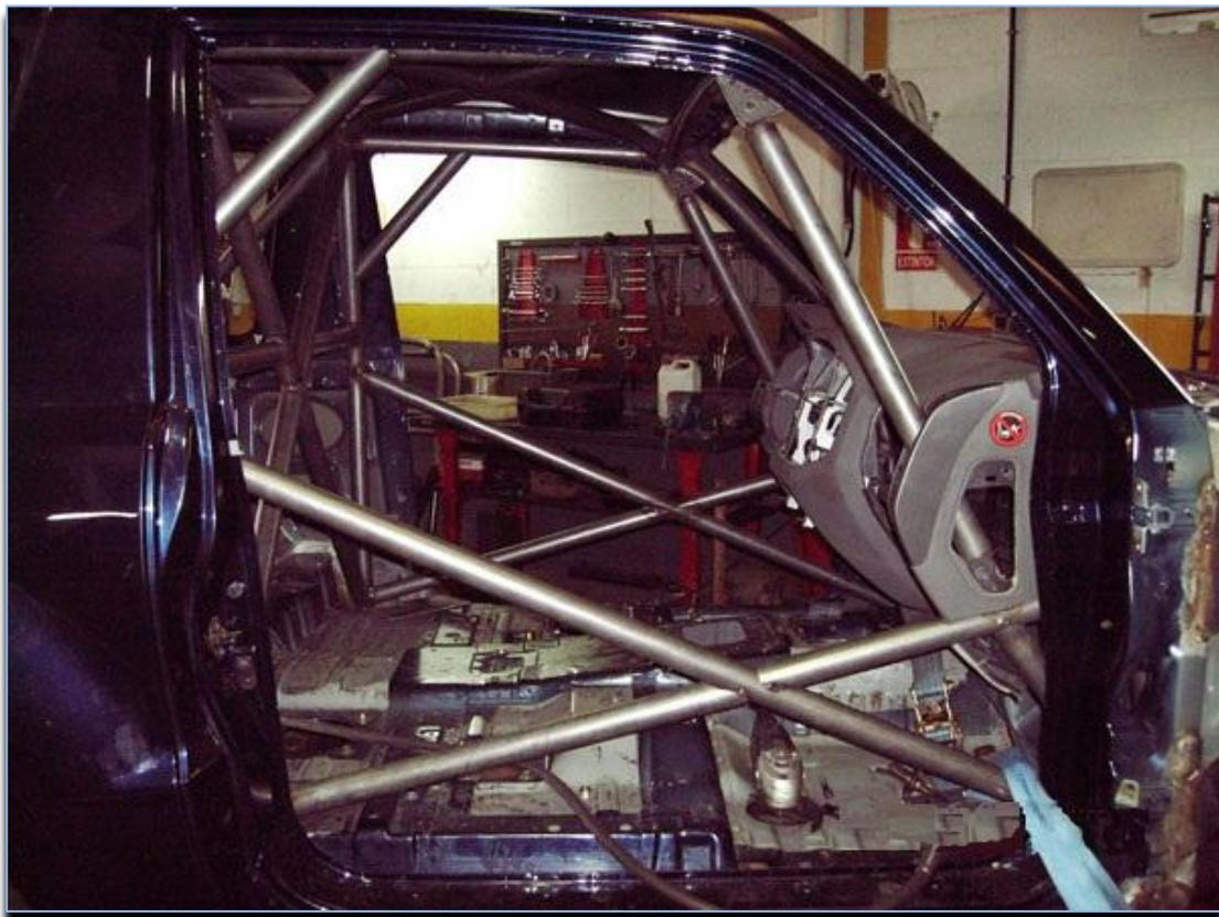
*Figura 144: instalación del salpicadero adaptado a la jaula (2)*
