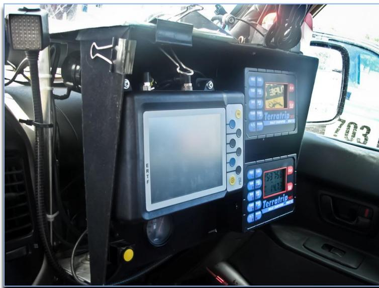
*Figura 185: Sistema Terratrip® y Gps Sentinel en su montaje final*
