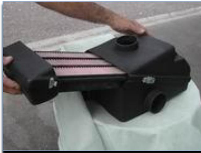
*Figura 14: Caja y filtro de aire de mayor capacidad del proveedor Snorkel.es, referencia SMM2*
