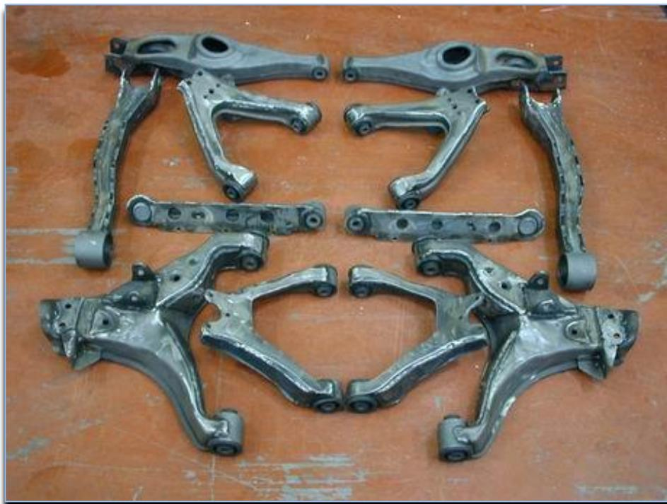
*Figura 76: Resultado orientativo del refuerzo realizado en el conjunto total de la suspensión*
