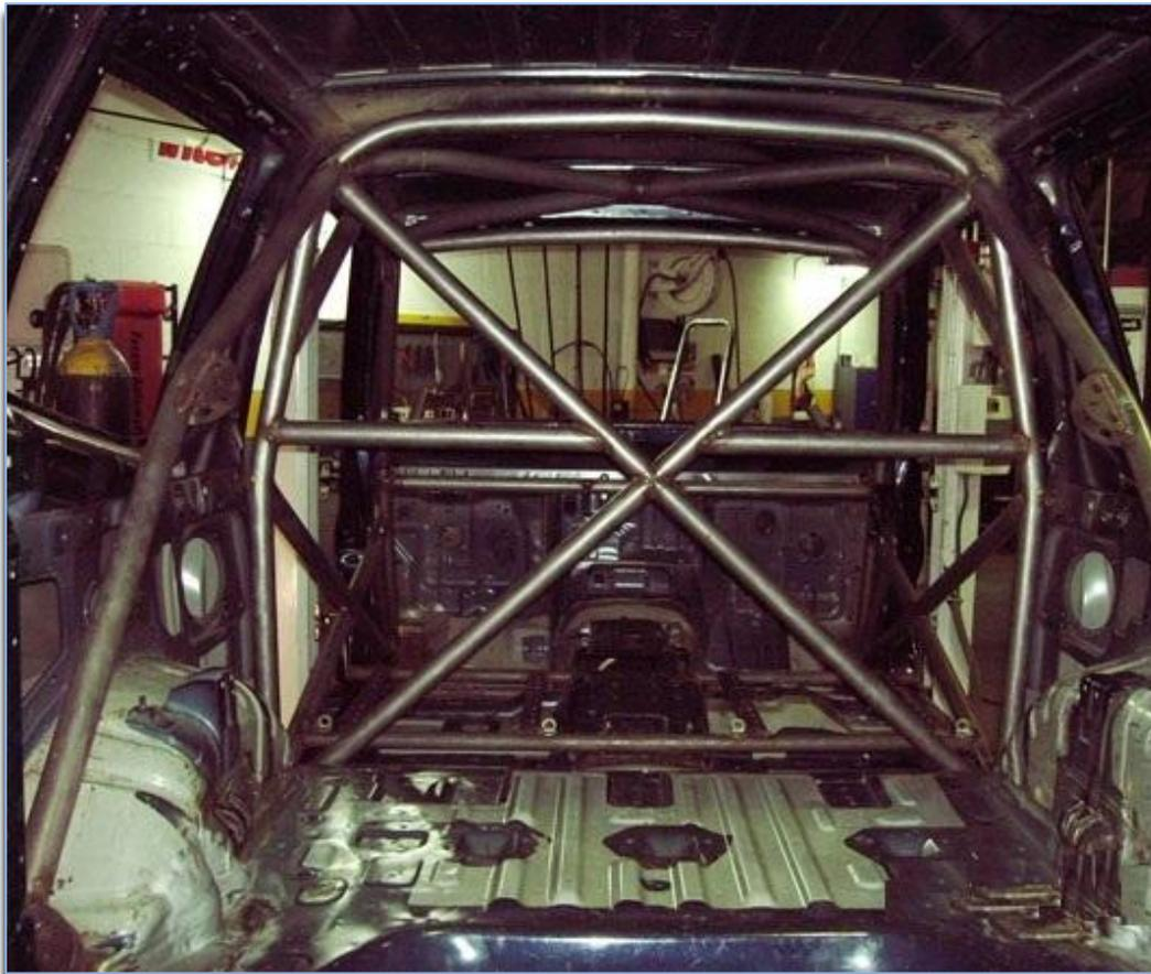
*Figura 142: Jaula de seguridad montada*
