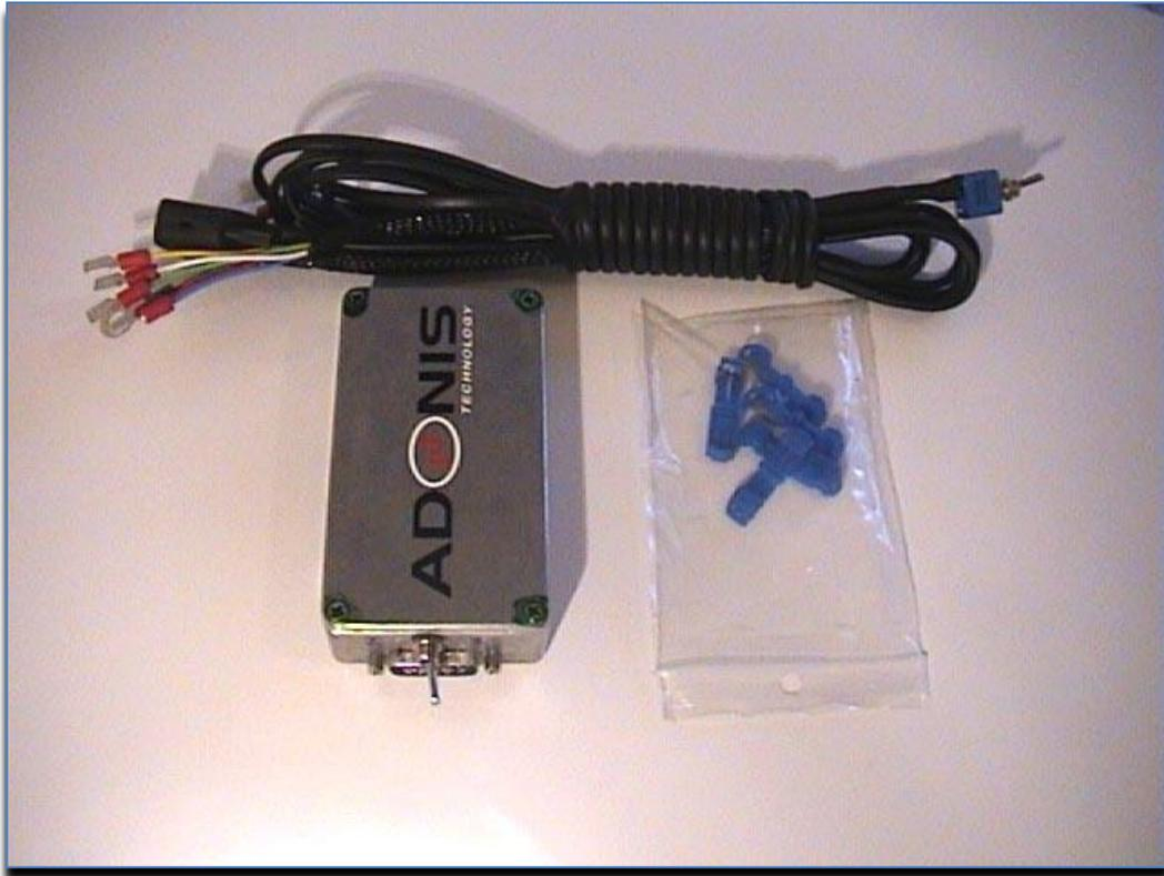
Figura 21: Kit de gestión de ECU del fabricante ADONIS technology con el mapeado específico para el vehículo del proyecto.
