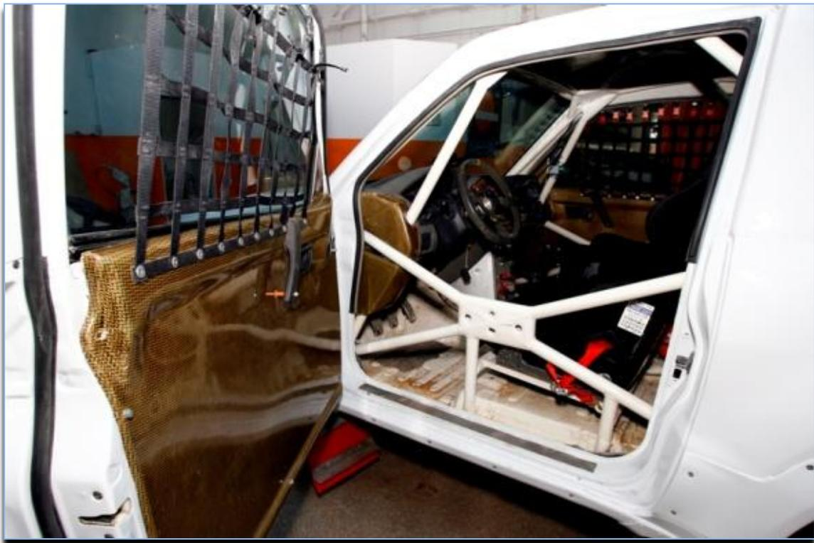
*Figura 179: Resultado final ilustrativo de la eliminación de ventanillas e instalación de redes de seguridad*
