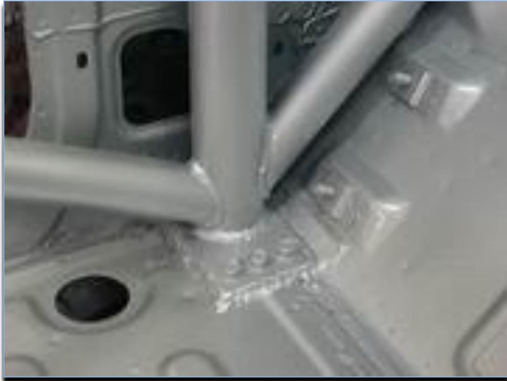
*Figura 147: detalle de uno de los anclajes de la estructura*
