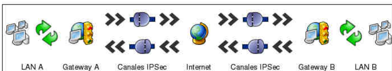
Figura 65: IPsec Modo túnel
