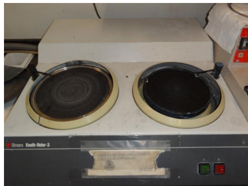
Fig. 3.1. Pulidoras empleadas en el desbaste y pulido.
