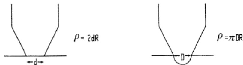
Fig. 2.27. Esquemas de la geometría del contacto puntual con la muestra.
