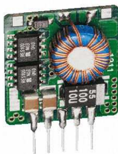
Figura 4.13: Convertidor Dc/Dc TSI 10N.
