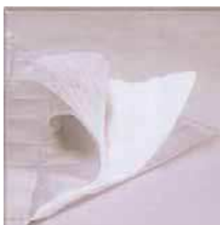
Figura 2.3 - Varias capas de Lightex superpuestas y cosidas
