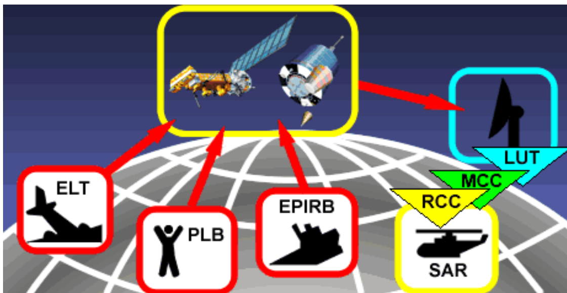
Figura 1.6 - Esquema del sistema de búsqueda y rescate (SAR)
