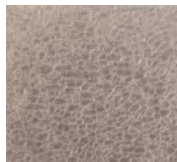
Figura 2.4 - Vista microscópica del tejido y sus cápsulas de aire
