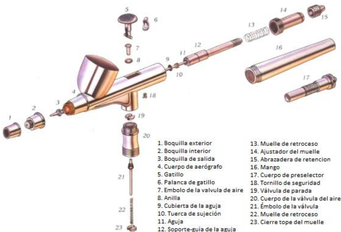
Figura 2.4 a) Despiece del aerógrafo BD-130E [29].
