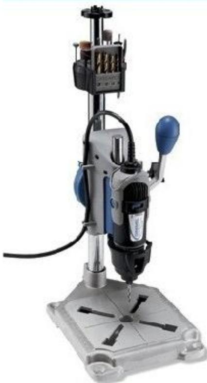
**Figura 2.6 Dremel montada sobre soporte.**
