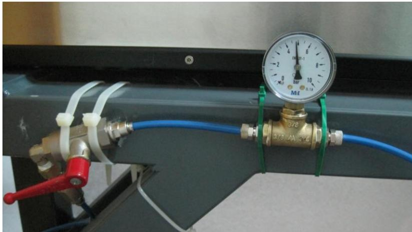
Figura 4.13 Colocación del manómetro. Se puede observar como la presión es ligeramente inferior a 5 bar.
