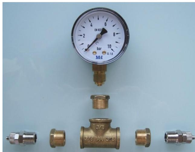
Figura 4.15 Detalle del montaje del manómetro.
