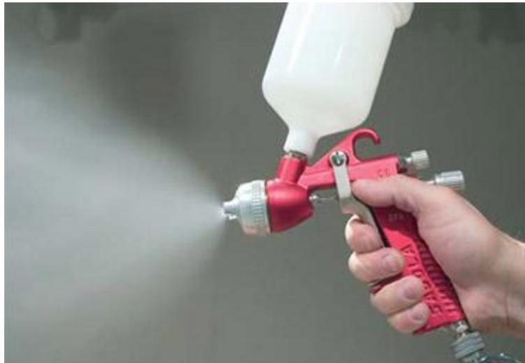
**Figura 2.2** Dispersión de pintura en una pistola de pintura.
