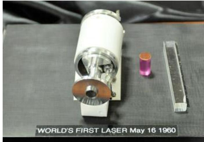
**Figura 1.3 Primer dispositivo láser inventado por Theodore Maiman [6].**
