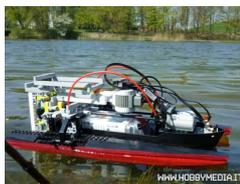
Figura 2.5: *NXT convertido en controlador de una lancha teledirigida.*
