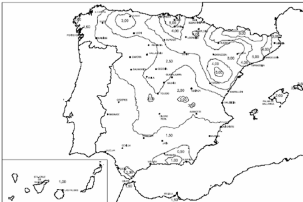
Figura 3. Mapa de densidad de impacto sobre el terreno Ng. (Fuente: catálogo C.T.E.)
