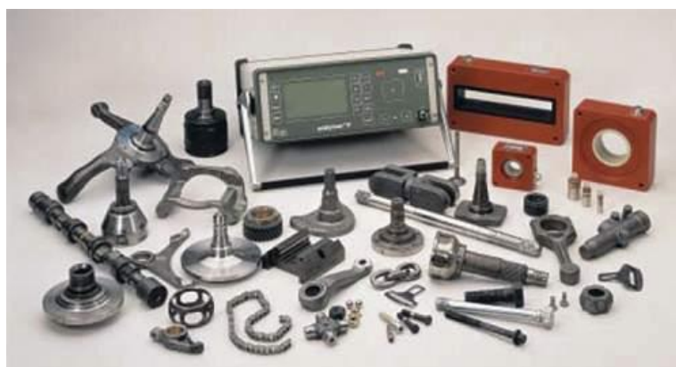
Ilustración 42: Ejemplo de equipo para analizar corrientes inducidas.
