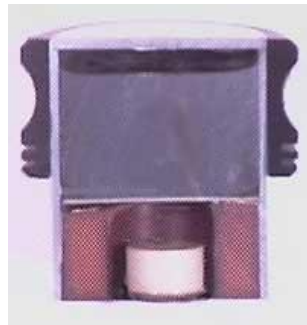
Ilustración 40: Sección de un transductor o palpador cerámico.
