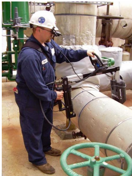
Ilustración 38: Ensayo de radiografía con equipo portátil.
