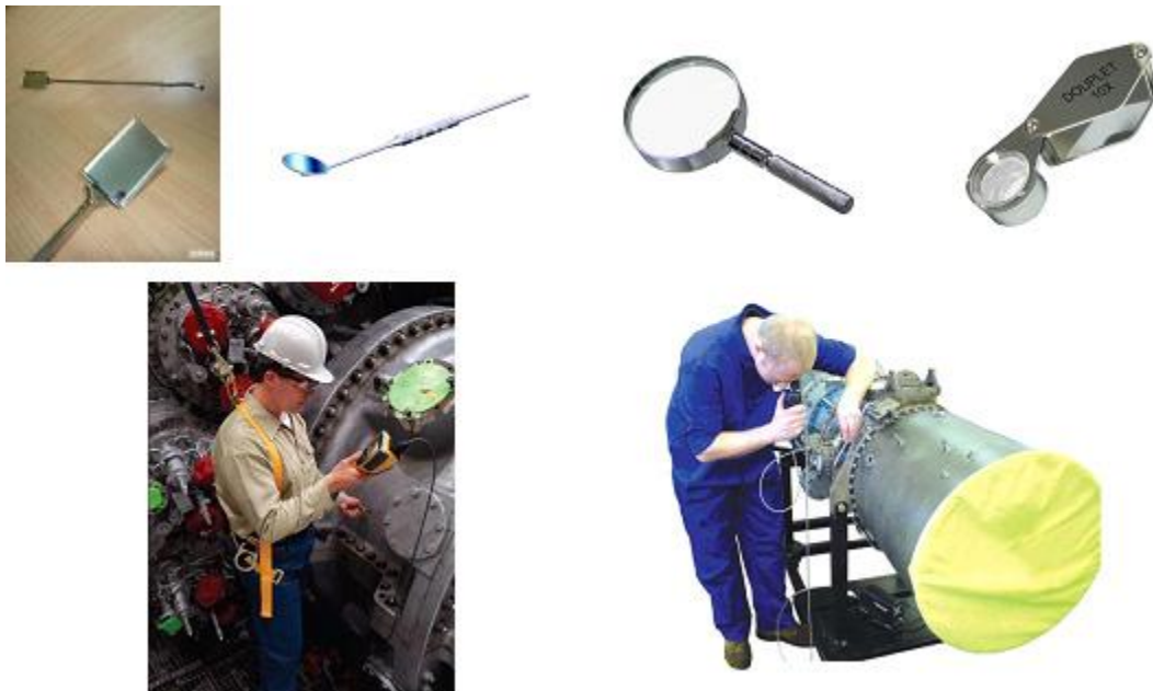
Ilustración 35: dispositivos utilizados en la inspección visual.
