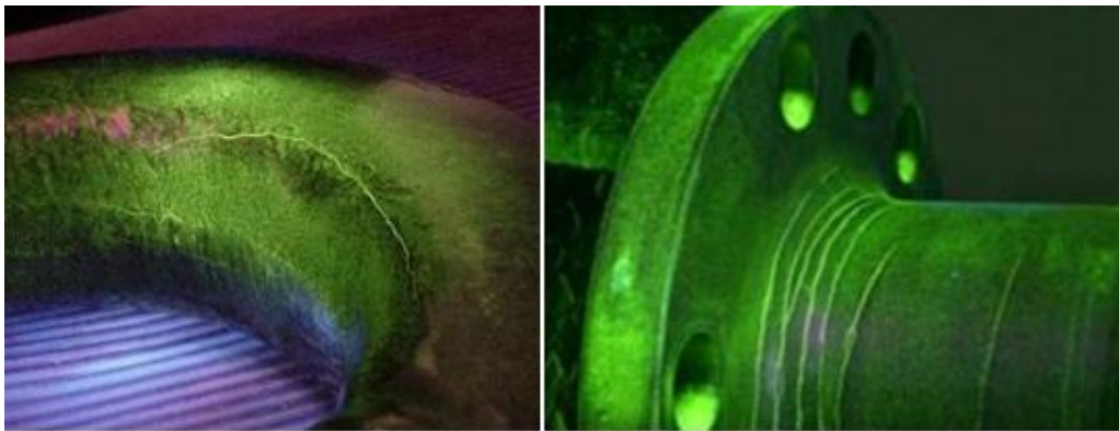
Ilustración 37: Defectos obtenidos mediante partículas magnéticas.
