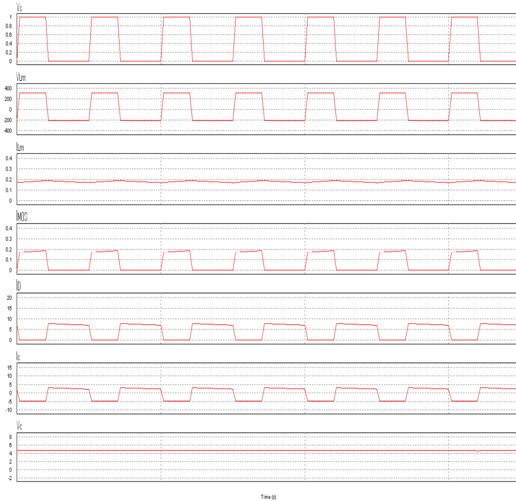
Figura 3.15: Formas de onda de un convertidor flyback
