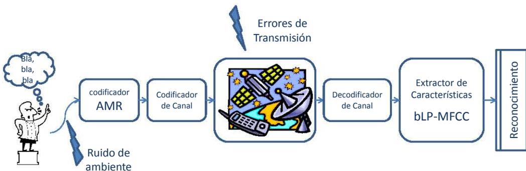
Figura 7.4: Modelo de transmisión de voz en UMTS, utilizando RMT.
