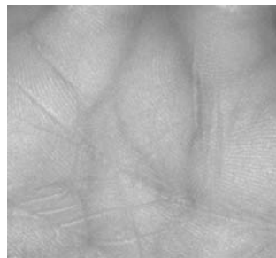
Figura 7: Imagen de venas utilizando cámaras CCD e iluminación por infrarrojos [VBS07]
