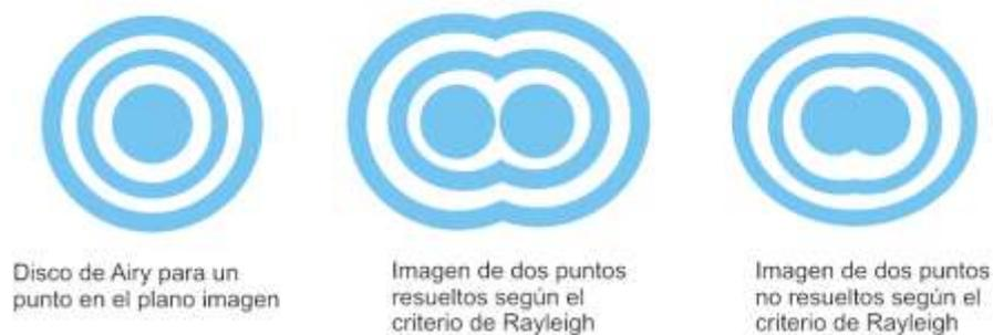
**Figura III.9:** Resolución de la imagen de dos puntos según el criterio de Rayleigh.
