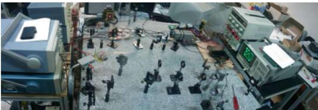
**Figura III.12:** Imagen del interferómetro homodino/heterodino de haz expandido de He-Ne.
