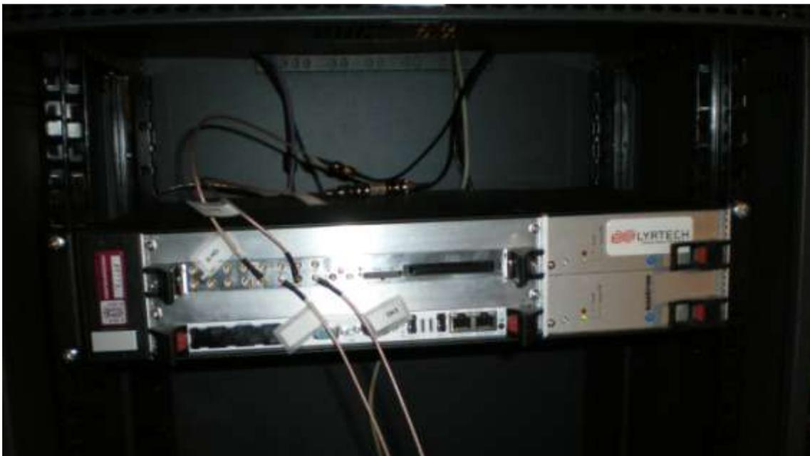
**Figura IV.20:** Sistema de detección de fase multicanal basado en tecnología FPGA.
