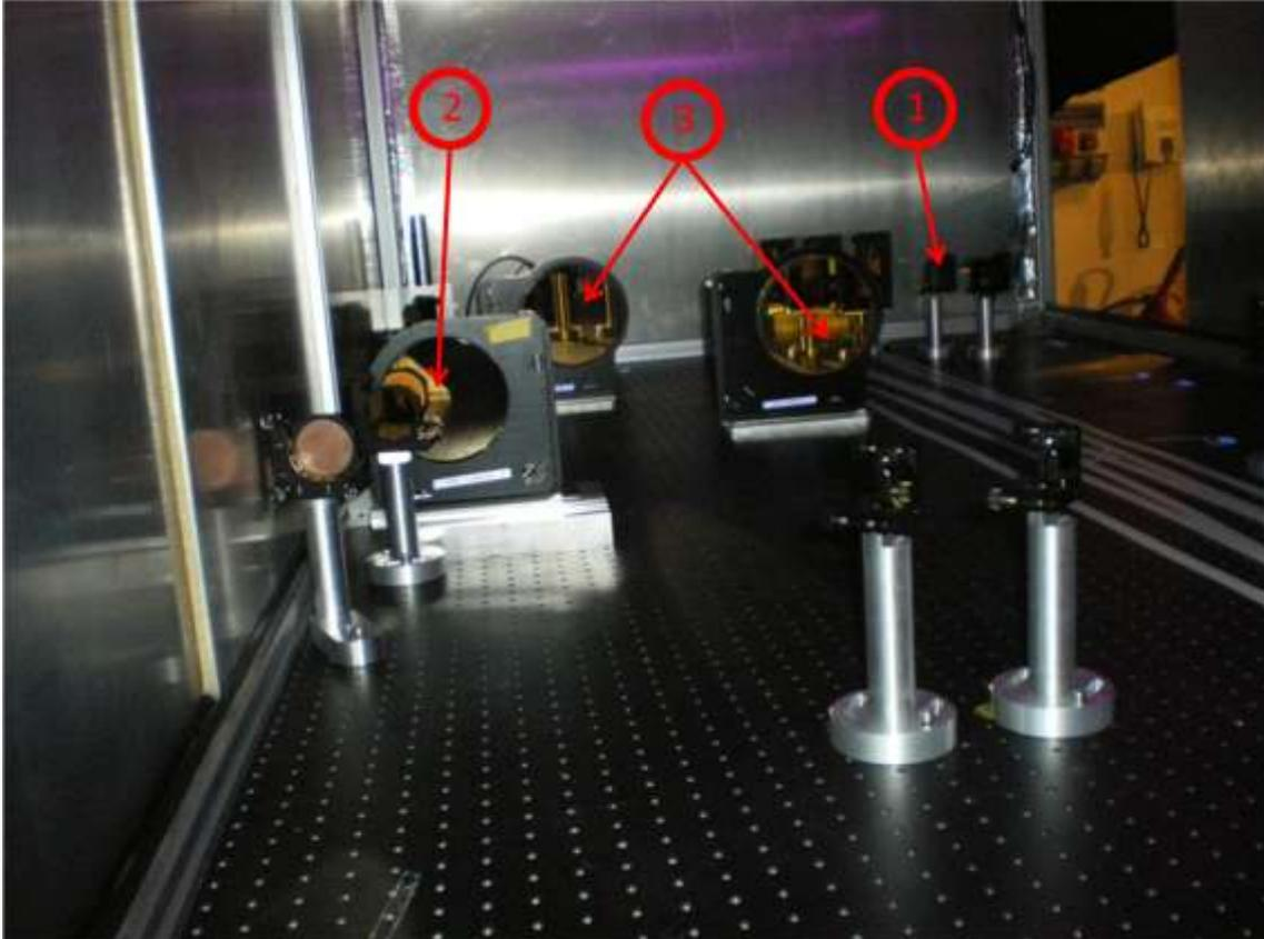
**Figura IV.12:** Detalle de los espejos esféricos de 2" del sistema de demagnificación (1) del brazo de referencia (SM8), del de 5" (2) del brazo de medida (SM3) y de los de 7" (3) de ambos brazos del interferómetro (SM2 y SM6).
