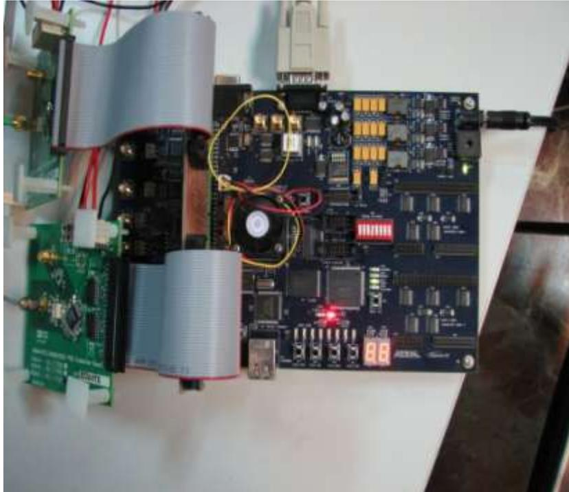
**Figura AII.2:** *Detector de fase multicanal implementado en una FPGA.*
