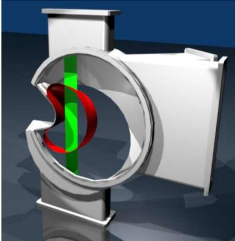
**Figura IV.11:** *Recreación en 3D del paso del haz expandido de 100mm (color verde) atravesando la sección del plasma (color rojo) que permite iluminar el puerto B1.*
