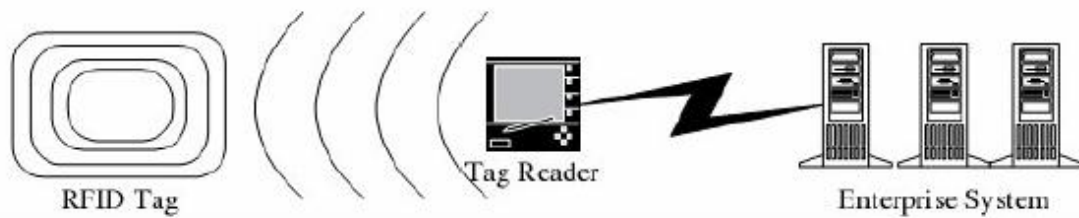
Figura 28. Comunicación de etiquetas RFID con lectores y sistemas informáticos.
