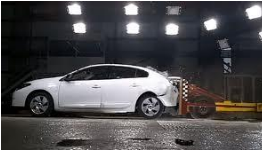
Figura 4. 9 Estado del coche al sufrir un ensayo por alcance.
