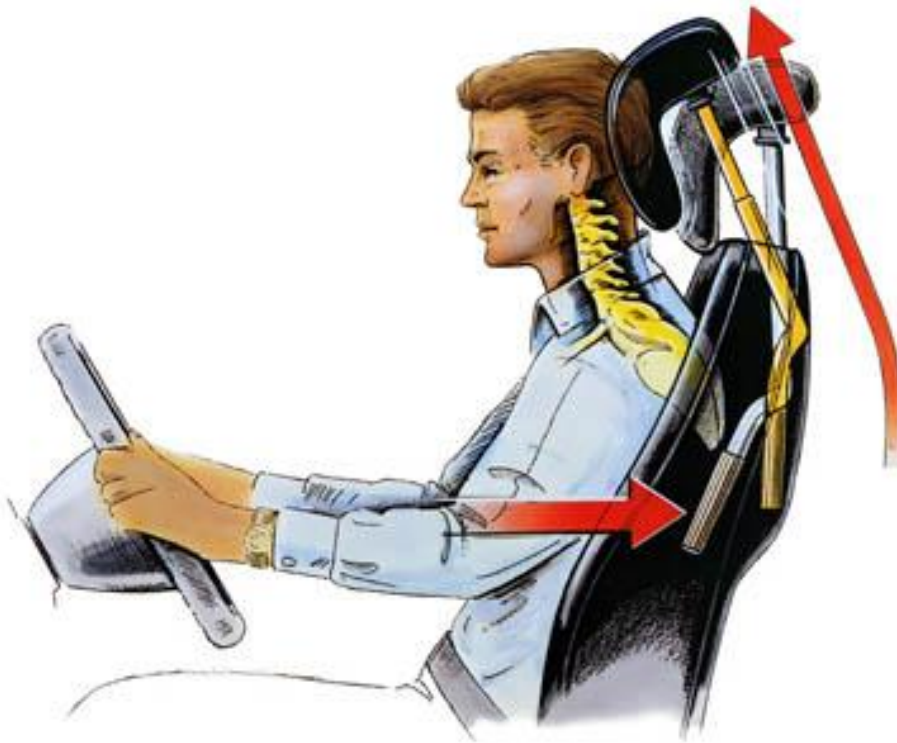
Figura 3. 10 Funcionamiento de un reposacabezas activo.
