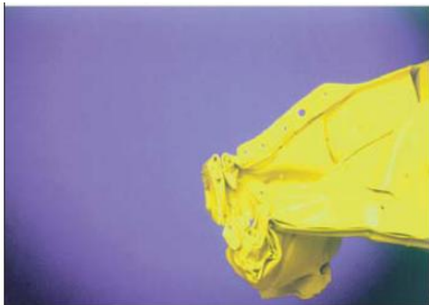
Figura 3. 2 Larguero piramidal después del choque.
