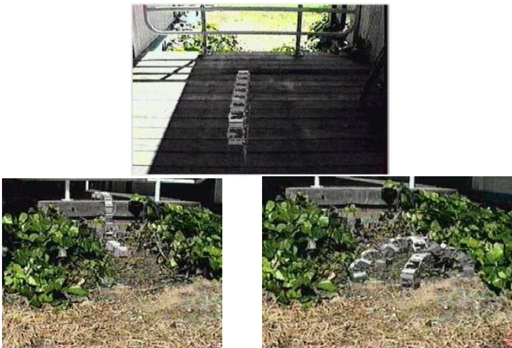
Figura 2.19. Configuración del robot Polypod en rueda, gusano y araña
