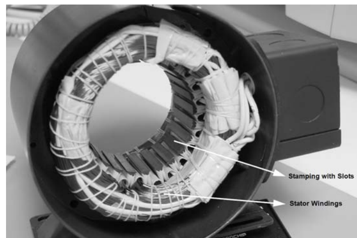
Figura 3.12. Topología de un motor DC brushless .
