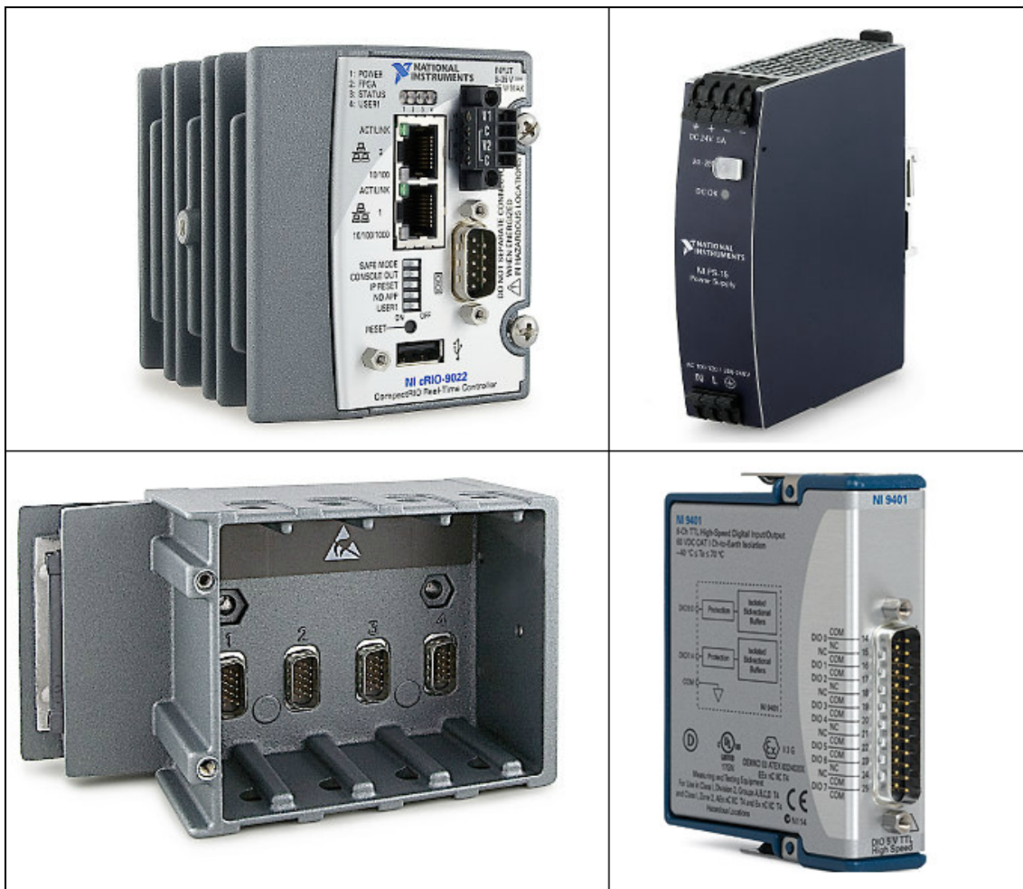
Figura 3.33. Componentes de la arquitectura de la CompactRIO: controlador Real-Time cRIO-9022, fuente alimentación NI PS-15 Power Supply, chasis reconfigurable cRIO-9113, módulo I/O digital y bidireccional High-Speed NI 9401.
