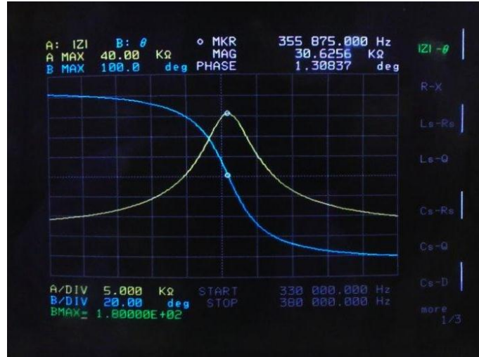
Figura 5-8. Ensayo de vacío. Frecuencia de resonancia
