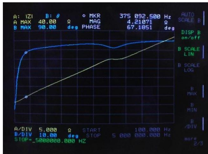
Figura 5-10. Ensayo de cortocircuito
