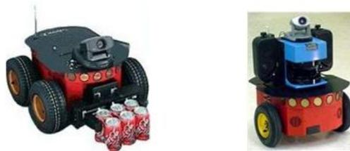
Figura 2. 8: Plataforma móvil sobre ruedas P2AT y P2DX
