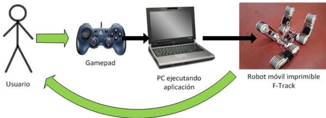
Figura 5. 2: Esquema del sistema de control
