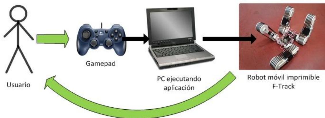
Figura 4. 4: Esquema sistema completo
