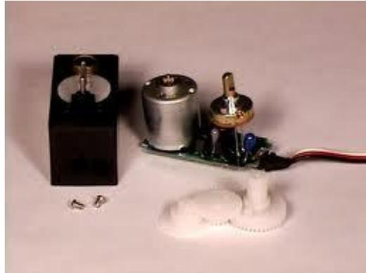
Figura 3. 5: Circuito interno de un servomotor
