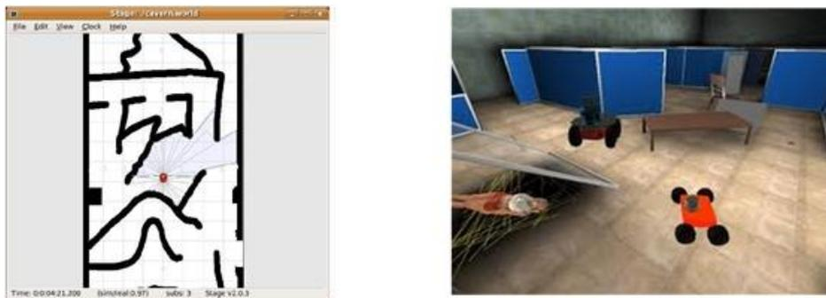
Figura 2. 12: Simulación de robots con Player/Stage y USARSim
