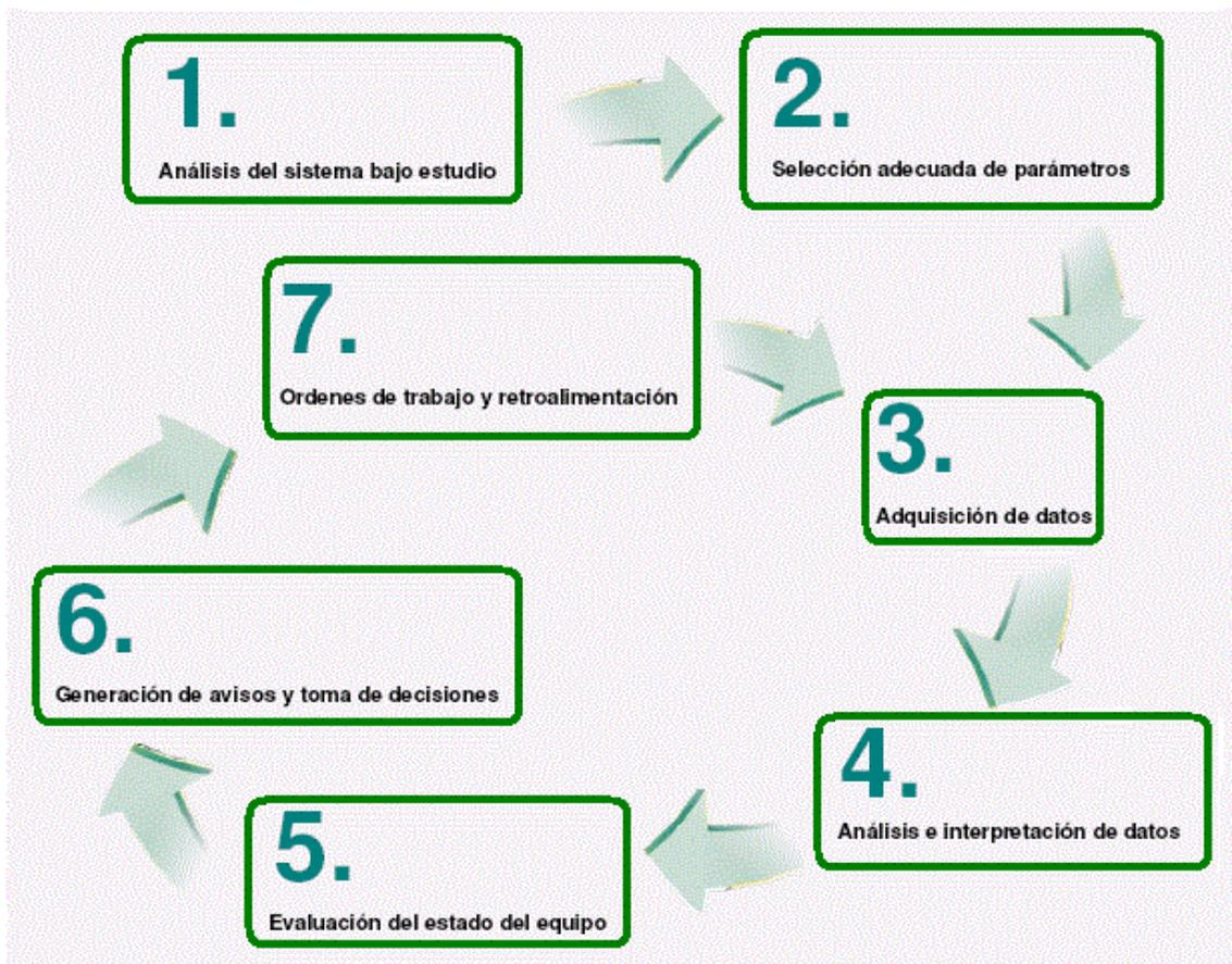
*Figura 43: Metodología de trabajo para implantar un sistema de mantenimiento predictivo.*
