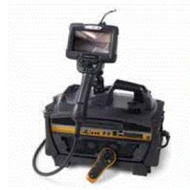
**Boroscopio XLG3 de la firma Videoprobe**
