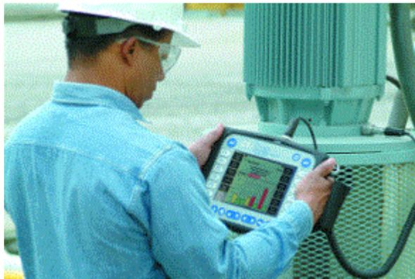
*Figura 36: Analista de vibraciones en plena ejecución de la técnica predictiva.*
