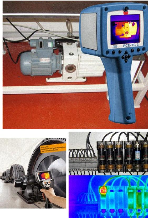
*Figura 35: Cámara infrarroja e imágenes que con ella se pueden obtener.*
