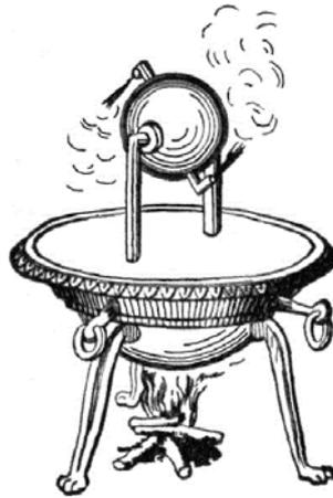
*Figura 4: Turbina de Herón (Eolípila).*
