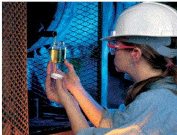
*Figura 37: Analista de aceites lubricantes en pleno proceso de toma de una muestra.*
