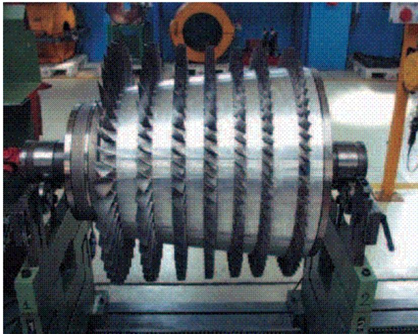
Figura 44: Compresor de una turbina de gas aeroderivada durante su reparación [16].
