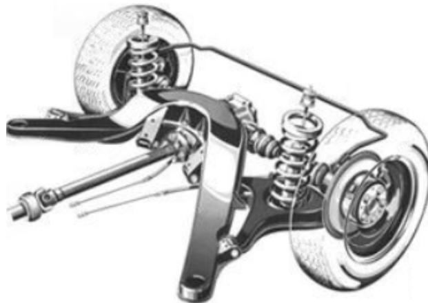
Figura 2.20: Esquema de una suspensión independiente de eje oscilante con una sola articulación
