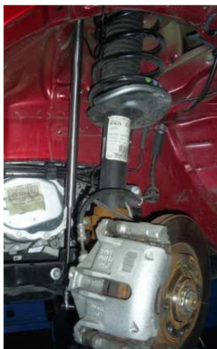
Figura 4.6: Ubicación del sensor de desplazamiento colocado en la suspensión izquierda
