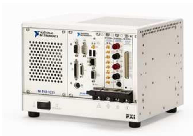
Figura 4.1: Chasis modelo NI PXI 1031DC
