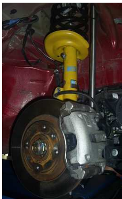
Figura 4.7: Ubicación del sensor de desplazamiento colocado en la suspensión derecha
