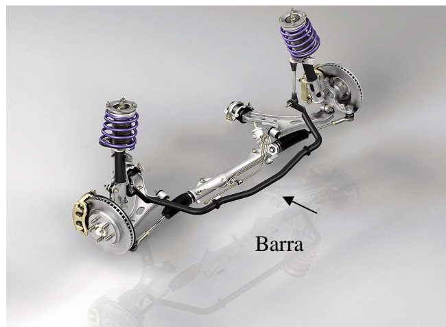
Figura 2.13: Barra estabilizadora en forma de U
