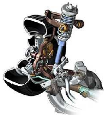
Figura 2.21: Montaje de una suspensión independiente multibrazo
