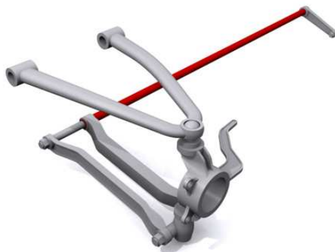
Figura 2.4: Esquema de una barra de torsión
