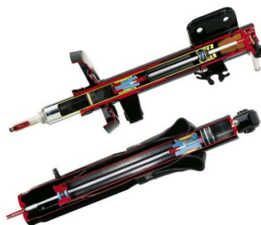
Figura 2.35: Vista en corte de un amortiguador magneto-reológico Magnetic Ride de Delphi
