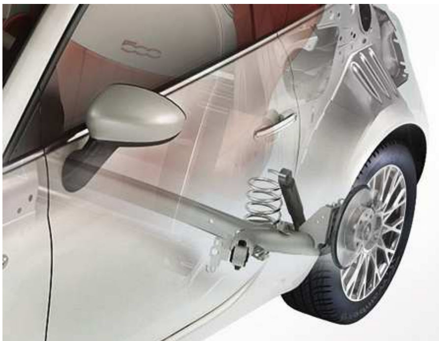
Figura 2.17: Esquema de una suspensión independiente de brazos arrastrados o tirados
