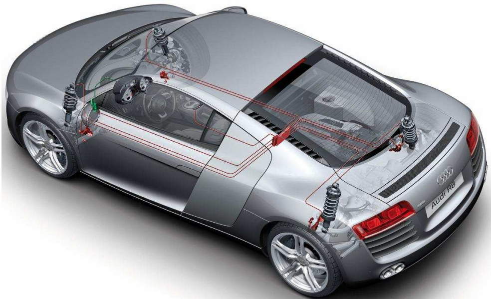
Figura 3.16: Montaje del sistema Magnetic Ride de Delphi en un Audi R8
