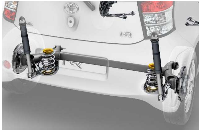
Figura 2.15: Vista trasera de una suspensión semirígida de eje torsional en un vehículo
