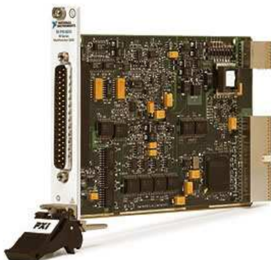
Figura 4.2: Módulo modelo NI PXI 6230
