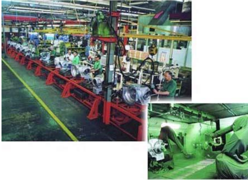
Línea de montaje y robots de pintura en el área de Cajas Pesadas
