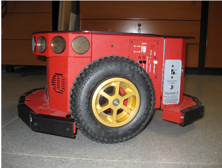
Figura 1: Aspecto lateral del robot Pioneer 3-DX
