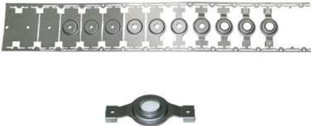
Figura 3.6 Ejemplo de banda de troquel en alimentación semiautomática. Obsérvese el principio y fin de la banda de chapa.
