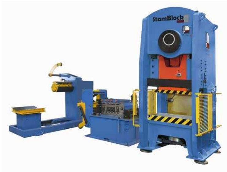
Figura 3.7. Línea automática de producción equipada con: Devanadora, Enderezador de banda, Alimentador y Prensa.
