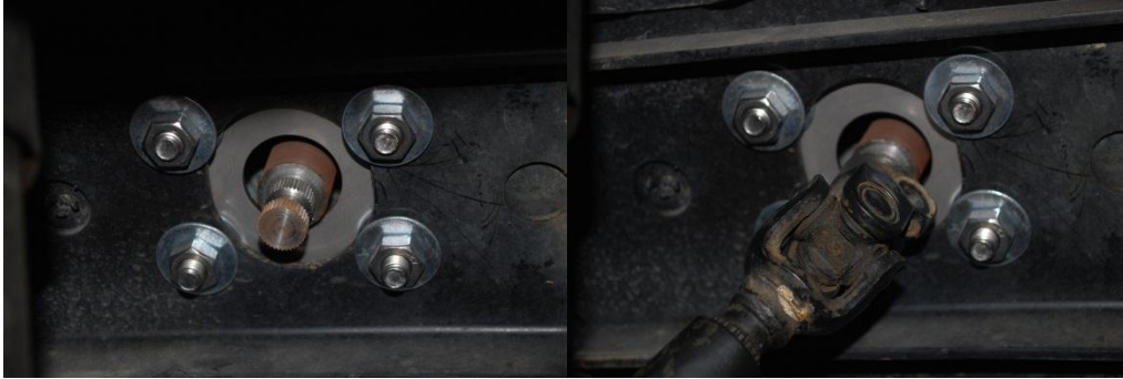
Figura 6.2 Montaje del conjunto motor. Detalle de la junta cardan
