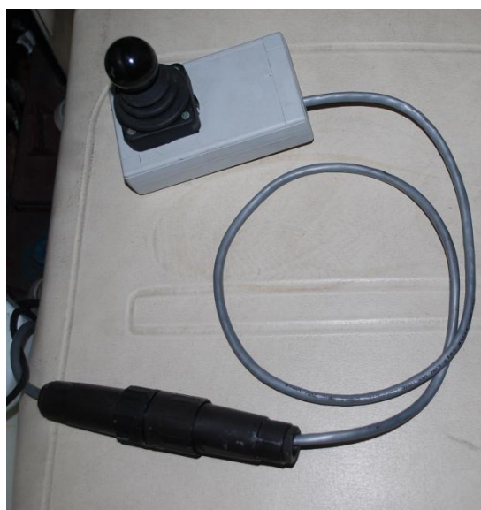
Figura 5.19 Cableado del Joystick
