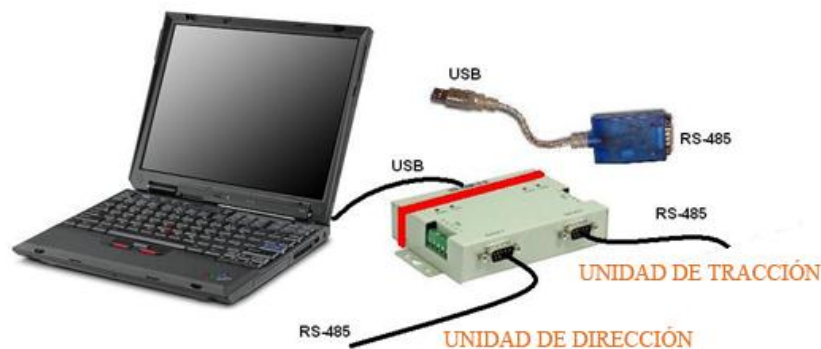
Figura 3.4 Esquema montaje de unidad de comunicaciones
