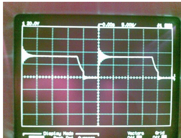
Figura 8.8 Sentido horario Ciclo de trabajo del 20 %
