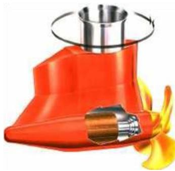
**Figura 132. Unidad de propulsión eléctrica.**
