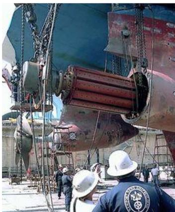
**Figura 134. Motor eléctrico montado en la hélice.**
