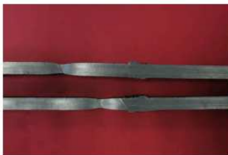
Figura 1. Tracciones transversales. La rotura se produjo por la zona del metal base.
