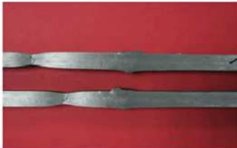
Figura 1. Tracciones transversales. La rotura se produce por la zona del metal base.
