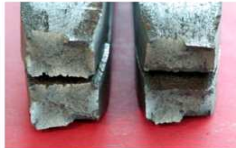
Figura 2. NICK BREAK. Detalle de las superficies de fractura.
