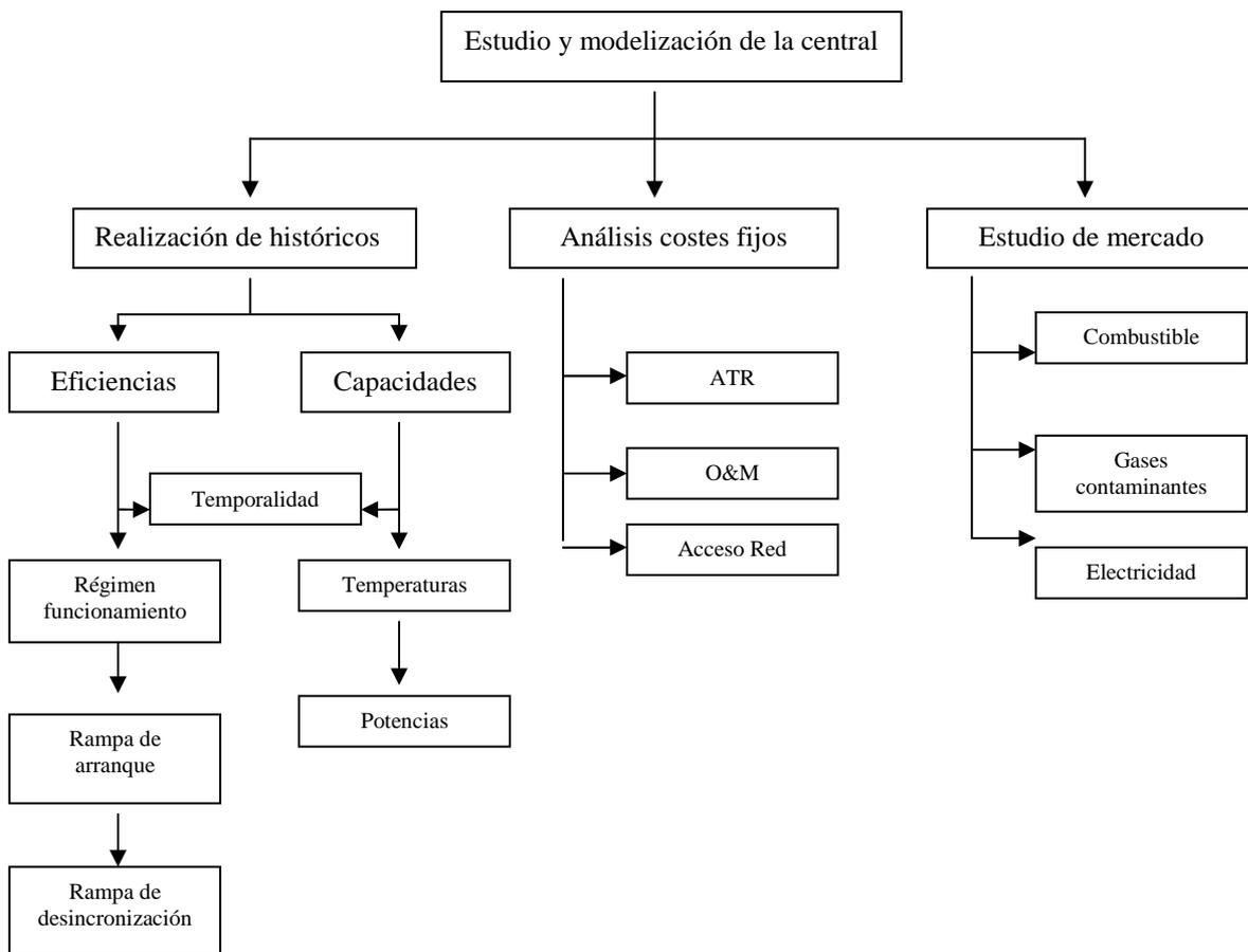
**Figura 21** Diagrama de Flujo del Optimizador
