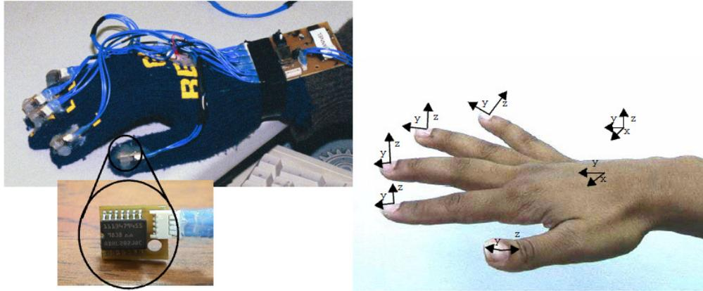
**Figura 8.** Imagen del prototipo de guante con sensores y movimientos detectados [34].
