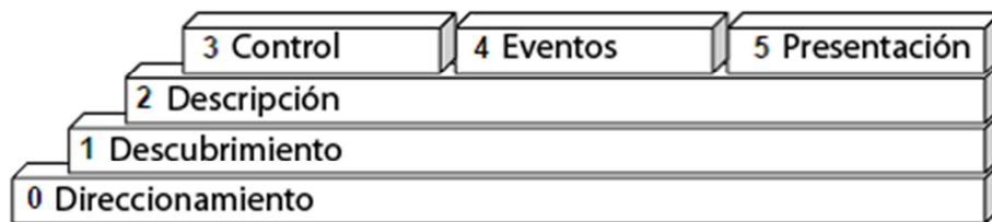
Figura 5: Esquema de las fases de comunicación en UPnP
