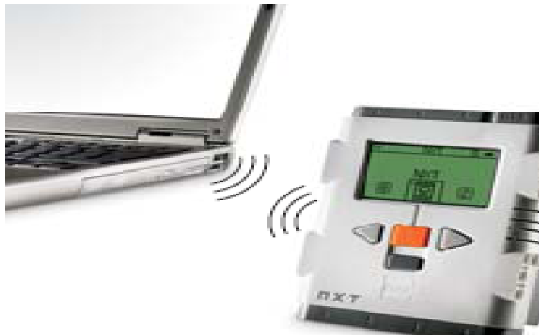
Figura 23. Conexión con PC mediante dispositivo Bluetooth
