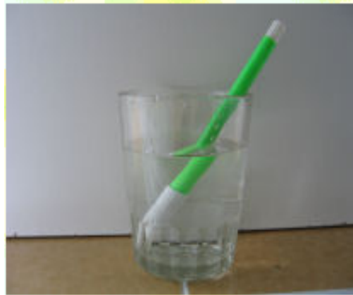
Figura 4. Refracción de la luz en objeto introducido en agua
