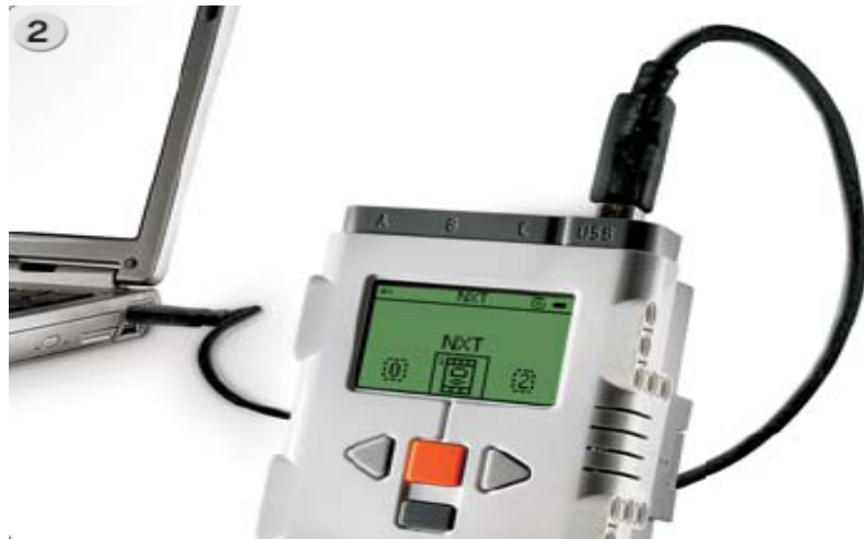
Figura 22. Conexión con PC mediante cable USB
