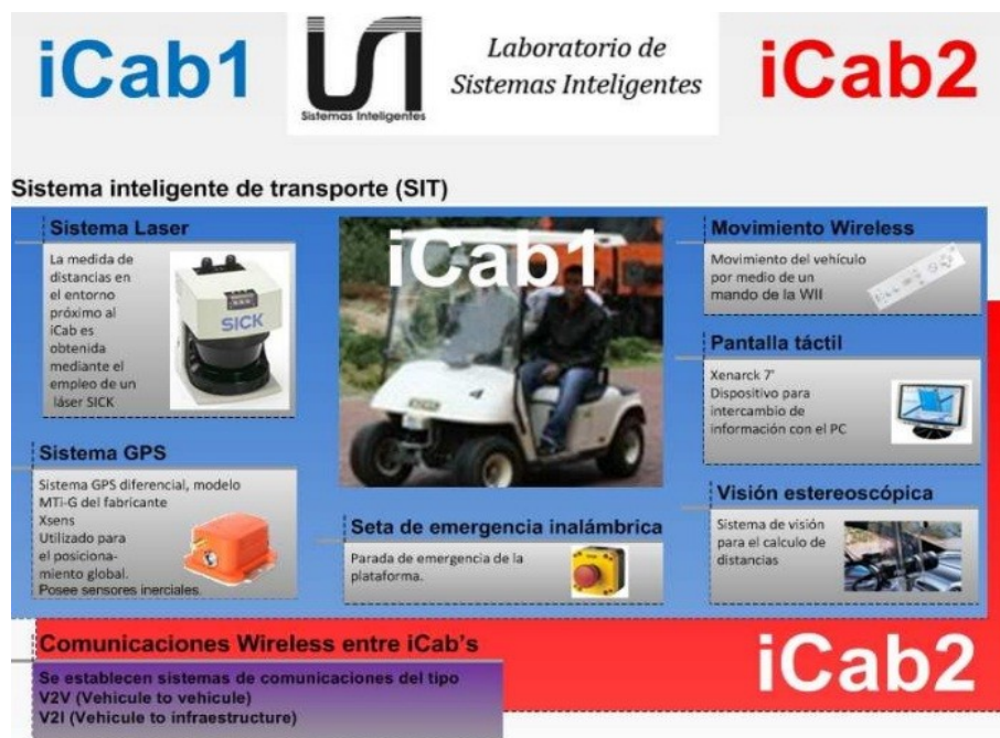
Figura 1.4: Plataforma iCab. Sensores y comunicaciones
