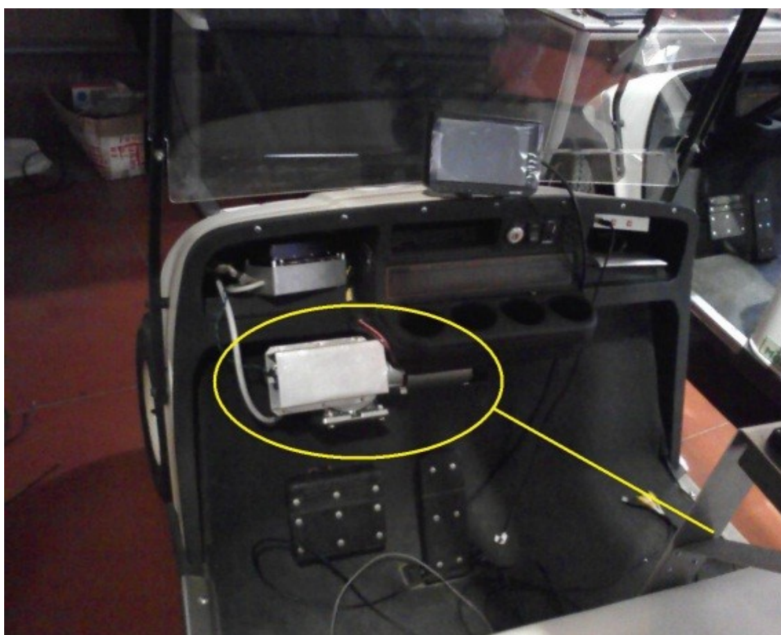
Figura 3.23: Implantación de la motorización de la unidad de dirección en el vehículo
