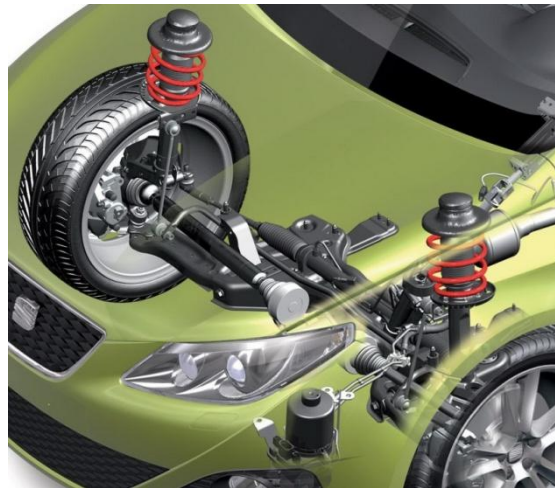
Figura 3.1. Suspensión McPherson. Seat Ibiza
