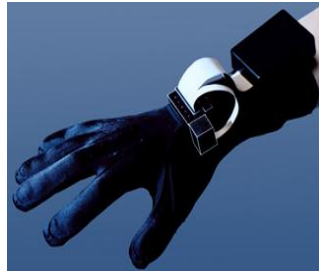
Figura 5.3. Guantes y sistema de tracking (posicionamiento)
