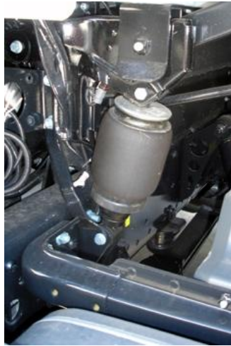
Figura 2.6: Ubicación en un vehículo industrial de un cilindro de suspensión neumático.
