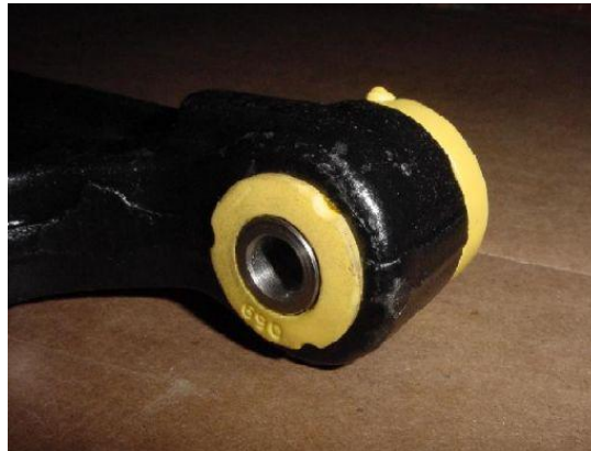
Figura 2.24: Fotografía de un silentblock o casquillo.
