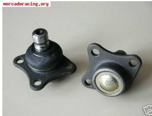
Figura 2.23: Rótulas utilizadas en una suspensión.
