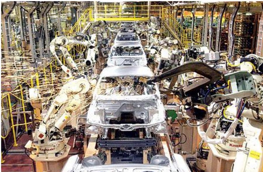
**Figura 1.1:** Robots en una cadena de montaje
