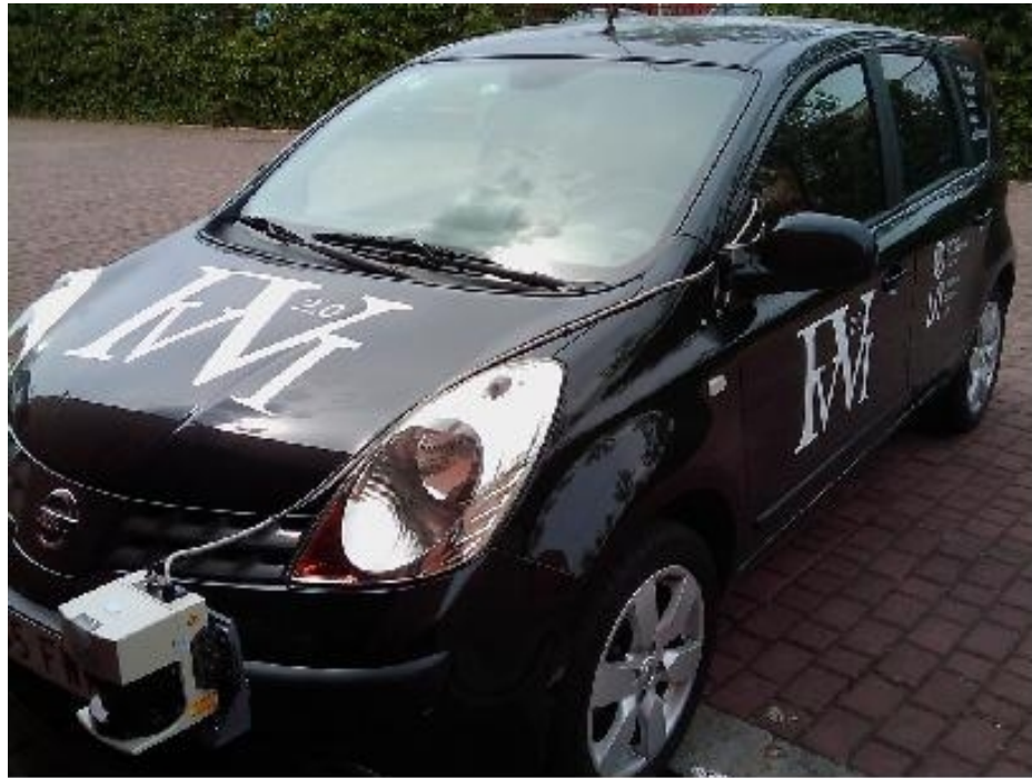
Figura 29: Configuración final del telémetro láser en el paragolpes delantero.
