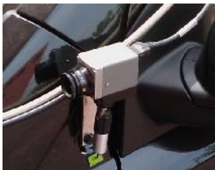
Figura 32: Configuración final de la cámara infrarroja en el retrovisor izquierdo.
