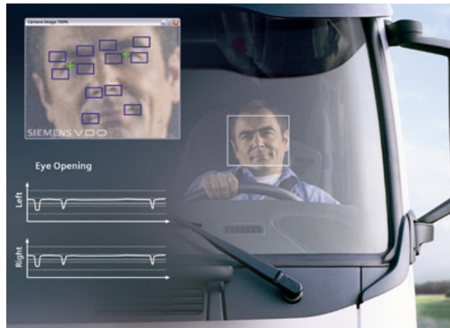
Figura 8: Sistema antisueño de Siemens.
