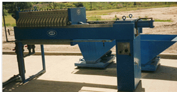
Figura 2-31, filtro prensa (obtenido de acsmedioambiente.com ).
