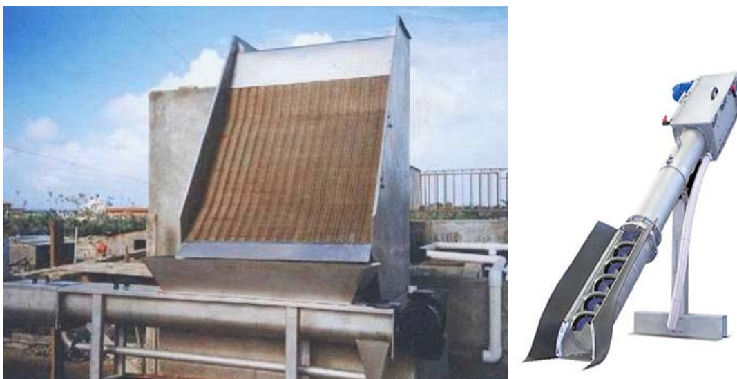
Figura 2-5, sistemas de tamizado, tamiz estático izquierda, tamiz de tornillo derecha.
