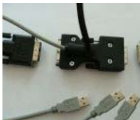
Figura 5.2. Conectores del HMD ARVision 3D.
