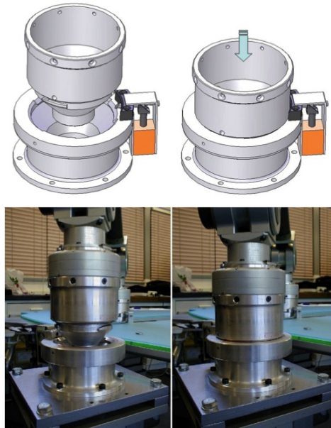
Figura 6.5: Diseño de anclaje implementado en el Brazo Robótico ASIBOT
