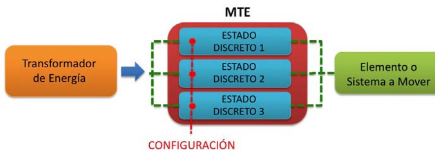
Figura 5.16: Configuración teórica de un Mecanismo de Tres Estados (MTE)
