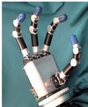
Figura 2.46: DLR Hand I - Centro de Investigación Aeroespacial Alemán
