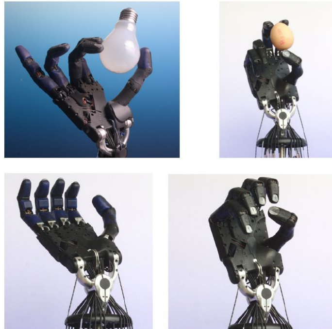
Figura 2.38: Ejemplos de manipulación y de movimientos de la Shadow Hand
