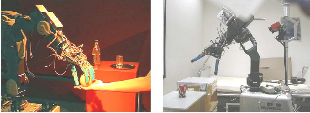
Figura 2.51: La DLR Hand II realizando tareas montada en un brazo robótico
