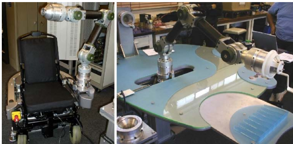
Figura 6.1: Brazo Robótico ASIBOT desarrollado por el Laboratorio de Robótica de la Universidad Carlos III de Madrid.
