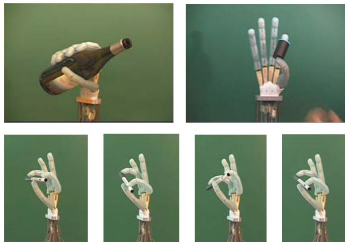
Figura 2.35: Ejemplos de manipulación y agarre de la UB Hand III
