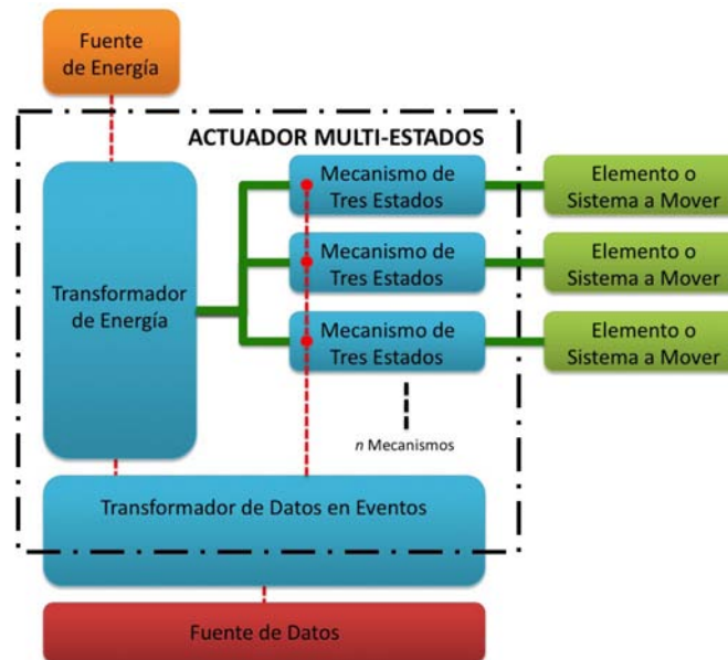
Figura 5.15: Configuración de un Actuador Multi-Estados (AME)
