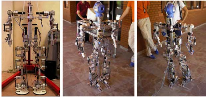
Figura 6.37: Robot Humanoide RH0 desarrollado por el Laboratorio de Robótica de la Universidad Carlos III de Madrid
