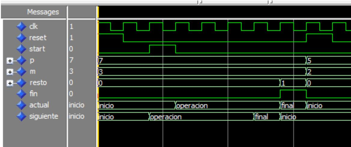
Ilustración 36: Simulación algoritmo No Restore Ring Reduction de 4 Bits
