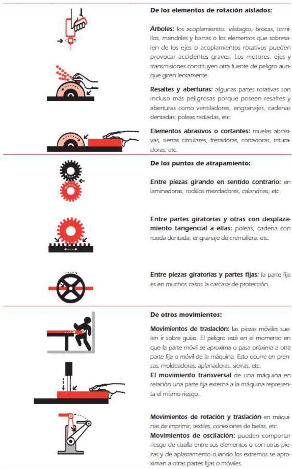
Figura 4.6: Riesgos de las partes móviles de las máquinas.
