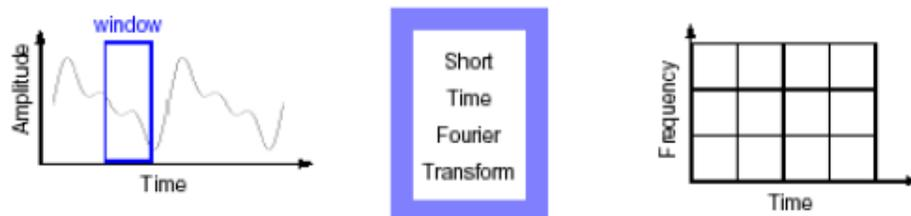
Ilustración 2. Short time Fourier transform
