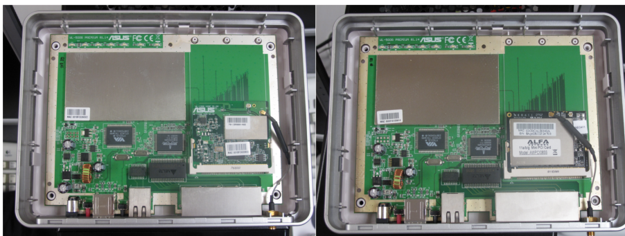
Figura D.1: Vista del interior del router móvil antes y después de cambiar la tarjeta inalámbrica original
