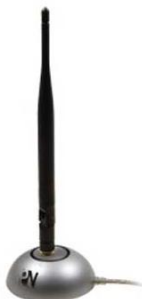
Figura D.4: Adaptador USB Linksys utilizado como interfaz inalámbrica adicional
