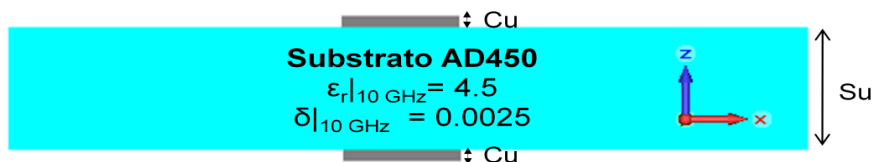
Figura 2. 15 Perfil del dipolo con SRR. Substrato AD450 en cian y el metal (cobre) en gris.
