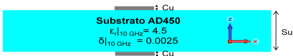
Figura 2. 46 Perfil del dipolo doblado con omega. Substrato AD450 en cian y el metal en gris.
