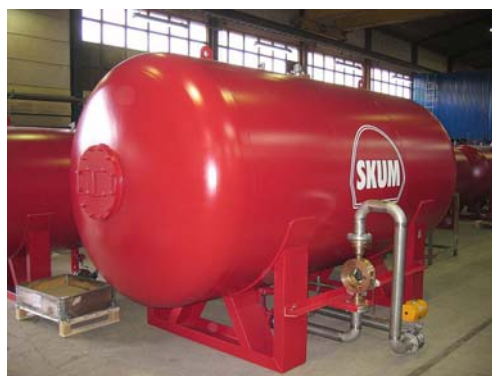
Figura 33. Depósito de reserva (Q insuficiente)
