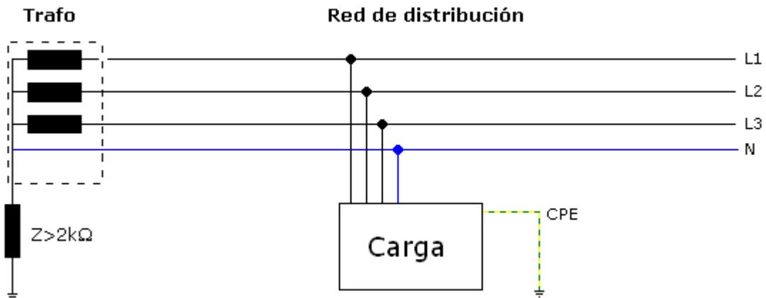
Ilustración 18. Esquema de Instalación IT
