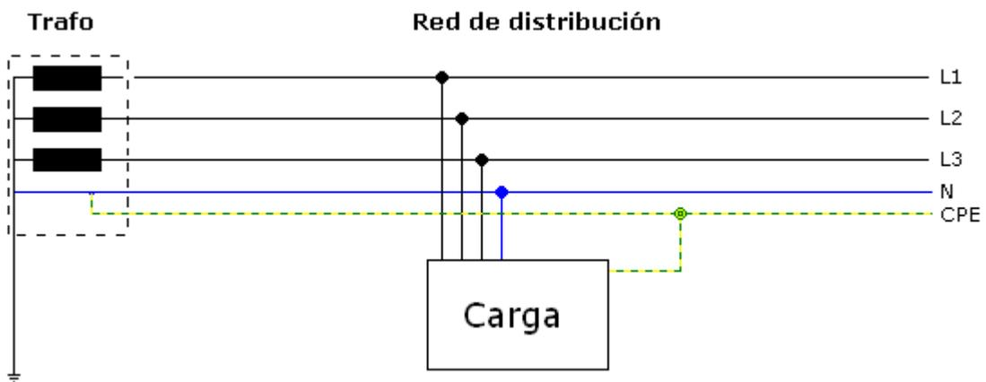
Ilustración 21. Esquema de Instalación TN-S
