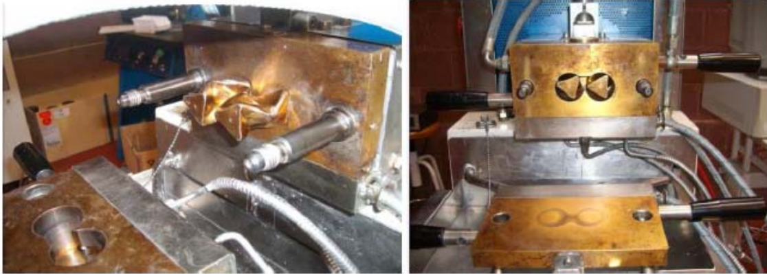
Figura 5.8. Vista de los rotores sin las zonas 2 y 3 (izquierda). Vista de la mezcladora sin la zona 3 (derecha).
