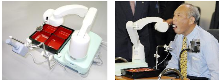
Imagen 8.23 - Dispositivo eléctrico para autoalimentación "My-Spoon", [17], [20]
